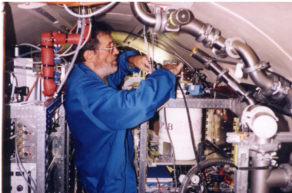
The cryogenic hygrometer inside the aircraft with Jacques Capus (here the Falcon, research aircraft from DLR –Deutsches Zentrum für Luft und Raumfahrt)
